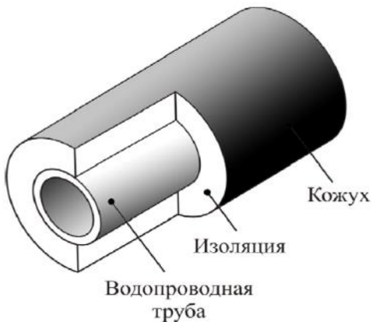
Рис. Схема предварительно изолированного теплопровода
