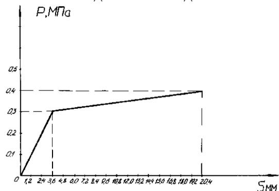
**Задача 14.** Определить модуль общей деформации по результатам компрессионных испытаний.
