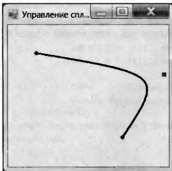
Рис. 18. Построение и изменение вида сплайна Безье
