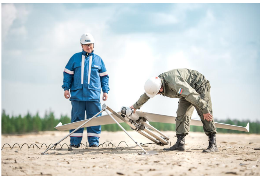
Рисунок 3 – Установка современного беспилотного летательного аппарата (БПЛА) для оценки загрязнения территорий
